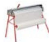
Idéale pour la pose de tous papiers peints unis ou avec raccords. Bac et capot inox, rouleaux de guidage aluminium, visserie laiton, rouleau encolleur PVC. Réglage de l'épaisseur de colle de chaque côté du bac à l'aide de 2 flèches de blocage et graduation pour un encollage régulier.
