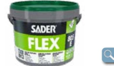
Permet de coller de nombreux revêtements de sols et convient sur sol chauffant et plancher rayonnant électrique. Pour les poses des PVC hétérogènes, moquettes, fibres naturelles et dalles semi-flexibles. Confort pendant et après travaux. Prise rapide, autorisant la mise en service dans les 18 à 24 heures.
