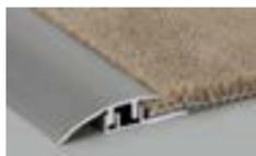
Fixation invisible : vissez la base et clipsez le chapeau sur la base. Les trous sont percés, fraisés puis ébavurés par-dessous. Livré avec vis et chevilles.
